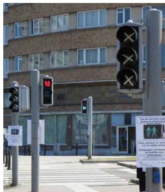
Dezelfde oversteekplaats, tijdens een test met dubbele lenzen.
